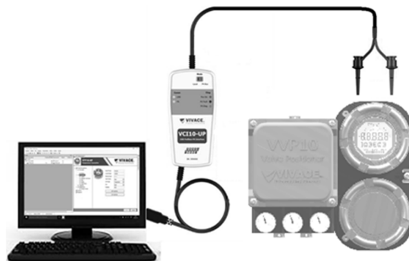
Figura 3.4 - Ligação da VCI10-UP ao VVP10 PROFIBUS.
